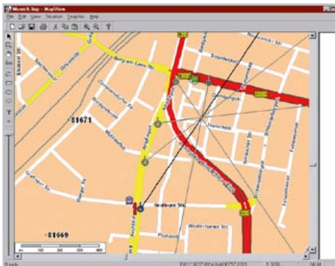
Ortung eines TETRA-Endgeräts mit Versiegelungspeilung und Darstellung auf der Landkarten-Software R&S®MapView.
